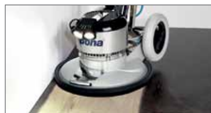
Komt dicht bij de muren - vermindert kantschuren
