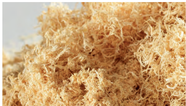
La poussière de ponçage d'un concurrent montre des signes d'arrachement des fibres
